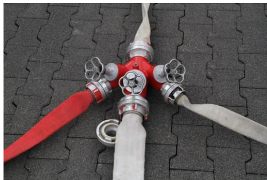
Abb. 26 Verteiler mit angeschlossenen Leitungen
